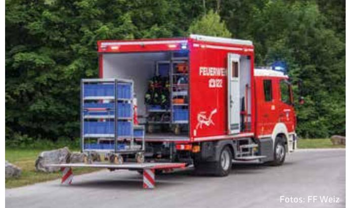
dieser über eine seitliche Zugangstür. Das Fahrzeug ist mit einer hydraulischen Ladebordwand ausgestattet, die Lasten bis zu 1.000 kg heben kann. Die im Aufbau integrierten Schienen ermöglichen eine schnelle und zuverlässige Ladegutsicherung.
